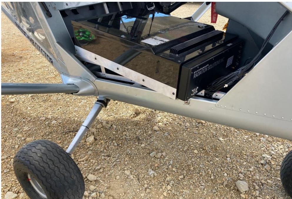
Рис. 4.4 - Блок детекторов аэрогамма-спектрометра RSX-5.
